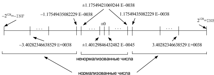
Рис. 4. Структура представления чисел в типе Single
